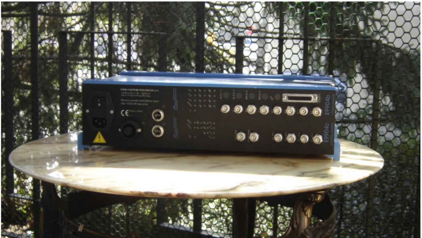
**Tempi – da 8 a 64 canali sincronizzati; tempo di apertura molto basso** (tempo minimo per l'acquisizione di due eventi successivi )
